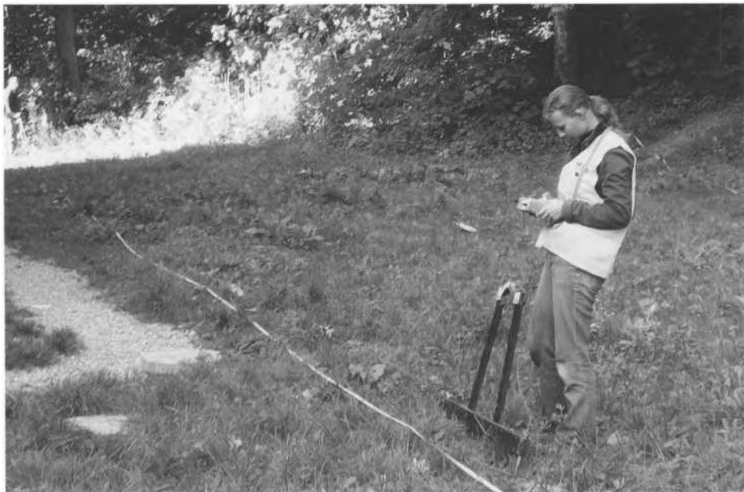
Pomiary elektrooporowe potwierdzają wyniki badań georadarem
